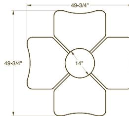
Plateaux indépendants concaves de 24,5" de largeur munis chacun d'un mécanisme d'ajustement en hauteur de 27" à 37"
