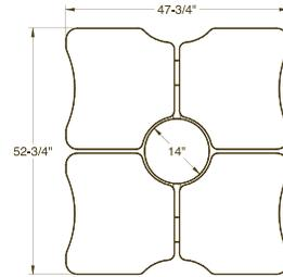
Plateaux indépendants concaves de 26" de largeur munis chacun d'un mécanisme d'ajustement en hauteur de 27" à 37"
