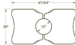
Plateaux indépendants concaves de 26" de largeur munis chacun d'un mécanisme d'ajustement en hauteur de 27" à 37"
